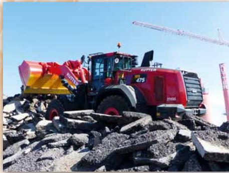
*Asphalt Fräsgut auf Halde zu schieben ist eine der Aufgaben, die der neue Komatsu WA475-10 bei Kutter im firmeneigenen Asphaltwerk bei Woringen übernimmt.*
