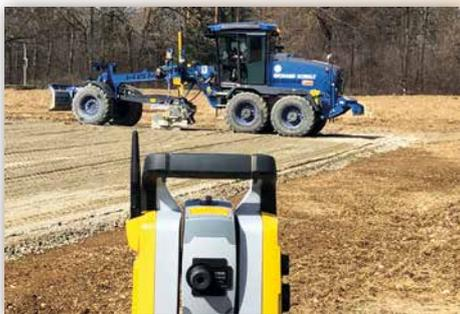
*Der HBM-NOBAS Grader BG 120TA-6 wurde mit einer 3D – Tachymetersteuerung, einem 3-Wege-Kamerasystem und einem hydraulischem Scharseitenblech direkt zur aktuellen Baustelle von Schulz gebracht.*
