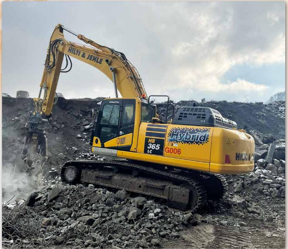
*Die zuverlässigen Baugruppen des Hybrid-systems von Komatsu wandeln die freigesetzte kinetische Energie in elektrische Spannung um und sorgen für einen kraftvollen und geräuscharmen Einsatz des HB365LC/NLC-3.*
