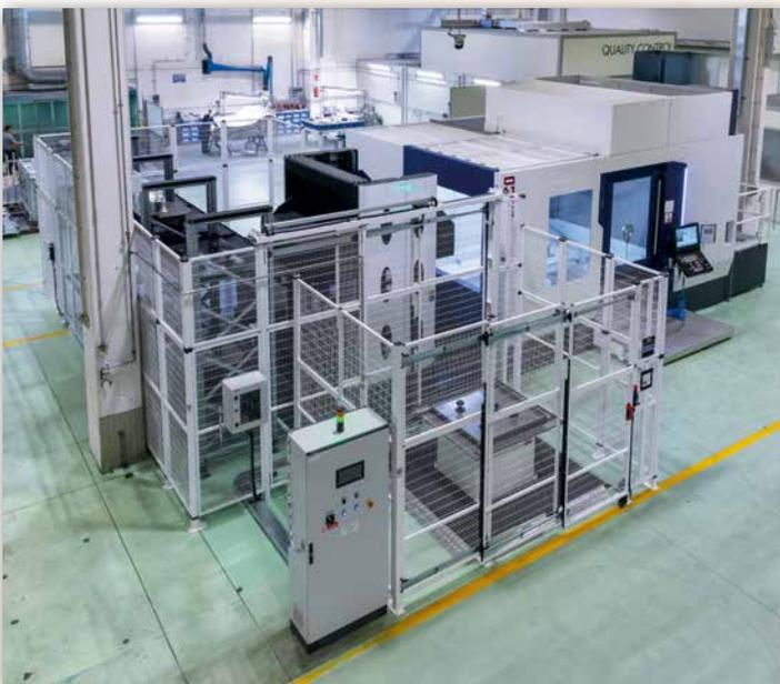
Universal-Bearbeitungszentrum UMILL 1500 mit automatischem Palettenwechselsystem mit 6 Stationen
