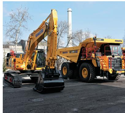
PC490LC-11EO s provozní hmotností 48,9 tun a výkonem 270 kW. Ve flotile firmy CEMEX se jedná o první rýpadlo Komatsu. Stroj, který se vyrábí v anglickém Newcastlu, byl dodán v lomové výbavě, která zahrnuje ochrannou mříž kabiny, skalní lopatu výrobce TRIGA MF (2,9 m<sup>3</sup>) nebo kryt lopatové pístnice. Kromě těžební lopaty dodal prodejce KUHN-BOHEMIA rovněž svahovku (2,5 m<sup>3</sup>) a hydraulické kladivo Furukawa typ FXj475.
